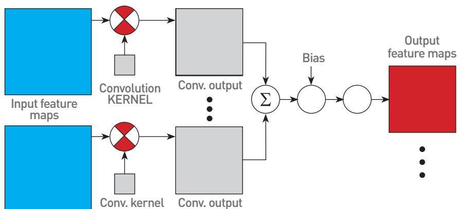
Fig. 3 : Convolution Layer (CN)
