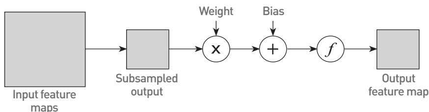
Fig. 4 : Pooling Layer
